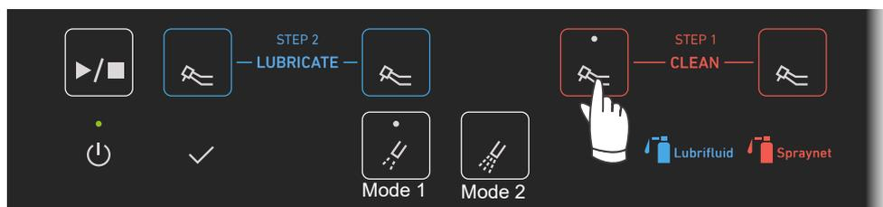
1. Appuyez sur les touches de sélection de la ligne souhaitées pour l'entretien des pièces à main. Les voyants correspondants s'allument en fonction des lignes sélectionnées. (Exemple : L'illustration ci-dessus montre que le Mode 1 est sélectionné pour une ligne de nettoyage.)
