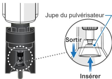
Mettez le dispositif hors tension. Retirez la jupe du pulvérisateur et remplacez-la par une neuve. Vérifiez qu'elle est installée dans le bon sens, tel qu'indiqué sur l'illustration.
