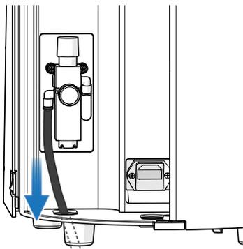
3. Tirez légèrement sur la conduite d'air pour vérifier qu'elle est correctement connectée. Ensuite, pulvérisez de l'air en ouvrant la valve d'air principale.
