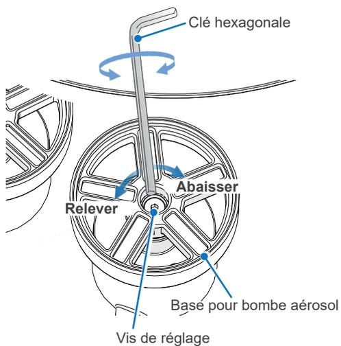
Si la bombe aérosol n'est pas correctement fixée en position verticale, alors même que le levier de verrouillage est bien en position haute, ou si vous ne parvenez pas à le lever, vous devez retirer la bombe aérosol et régler la hauteur de la base pour bombe aérosol.
