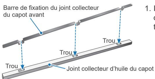
1. Insérez la barre de fixation du capot avant dans le joint collecteur d'huile en alignant les petites butées de la barre de fixation avec les trous de l'absorbeur.
