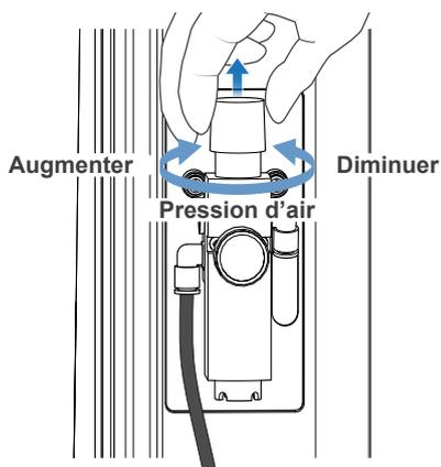
4. Tirez la molette de réglage du régulateur d'air vers le haut, puis tournez-la pour régler la pression d'air entre 0,3 MPa et 0,5 MPa.
