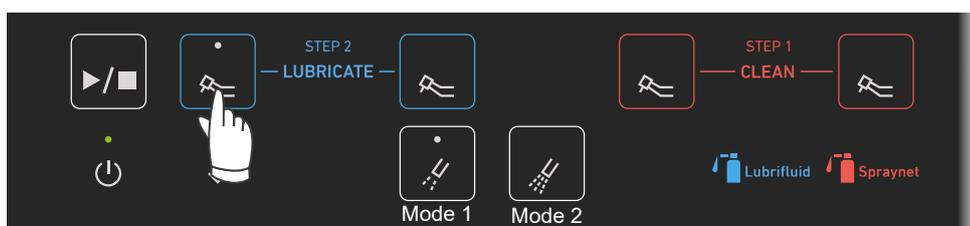
1. Appuyez sur les touches de sélection de la ligne souhaitées pour l'entretien des pièces à main. Les voyants correspondants s'allument en fonction des lignes sélectionnées. (Exemple : L'illustration ci-dessus montre que le Mode 1 est sélectionné pour une ligne de lubrification.)
