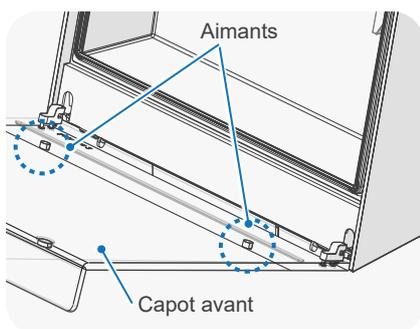
2. Alignez les aimants du capot avant avec les butées métalliques de la barre de fixation afin de maintenir en place l'absorbeur d'huile.
