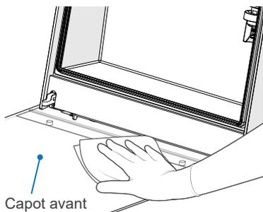
2. Retirez l'absorbant d'huile du capot usagé et la barre de fixation, puis nettoyez l'intérieur du capot de la même manière que pour la surface de l'unité.
