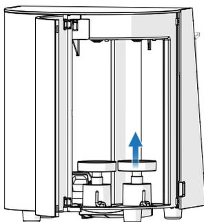
Pour remplacer la base pour bombe aérosol, retirez l'ancienne base en la soulevant et installez la nouvelle base en poussant vers le bas.
