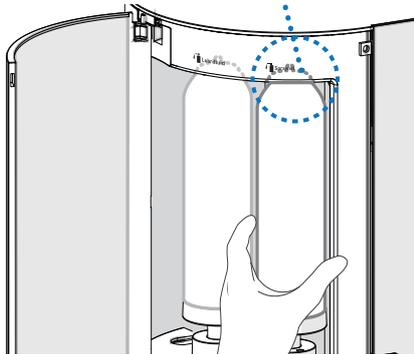
2. Tenez la bombe aérosol d'une main et soulevez le levier de verrouillage dans le sens antihoraire. Vérifiez que la bombe aérosol est correctement maintenue en position verticale.
