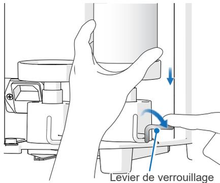
1. Baissez le levier de verrouillage en le tournant dans le sens des aiguilles d'une montre.
