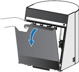
1. Mettez le dispositif sous tension à l'aide de l'interrupteur d'alimentation et ouvrez le capot avant afin que la procédure de modification du mode ne provoque aucun dysfonctionnement du dispositif Lubricare 2.
