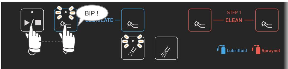
2. Restez appuyé sur la touche de sélection de la ligne souhaitée et appuyez sur la touche Marche/Arrêt pendant environ 2 secondes, jusqu'à ce que vous entendiez un signal sonore unique et continu. Le voyant de sélection de la ligne et le voyant de sélection du mode de lubrification actuellement défini clignotent.
