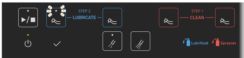
4. Le voyant de fonctionnement ainsi que les deux voyants de sélection du mode s'allument lors du fonctionnement du Mode Rinçage. De plus, le voyant de sélection de la ligne de la ligne en cours de rinçage clignote.
