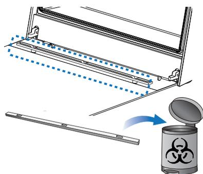
Retirez le joint collecteur d'huile du capot de la barre de fixation et remplacez-le par un neuf.
