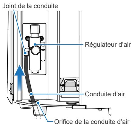
2. Insérez la conduite d'air dans l'orifice de la conduite d'air et insérez-la fermement dans le joint de la conduite. Reliez l'autre extrémité de la conduite d'air à la valve d'air principale.
