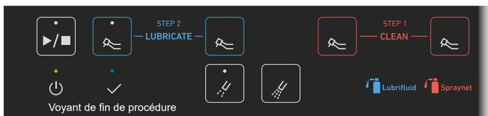
5. Lorsque le Mode Rinçage est terminé pour toutes les lignes sélectionnées, un signal sonore unique et continu retentit et le voyant de sélection de la ligne ainsi que le voyant de fin de procédure s'allument.
