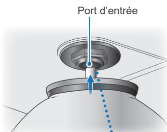
1. Ouvrez le couvercle arrière (D), puis insérez l'extrémité de la tige de la valve de la bombe dans le port d'entrée.
